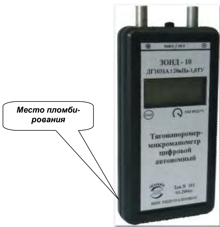
Рисунок 1— Тягонапоромер— микроманометр цифровой автономный ЗОНД-10-ДГ1031А
